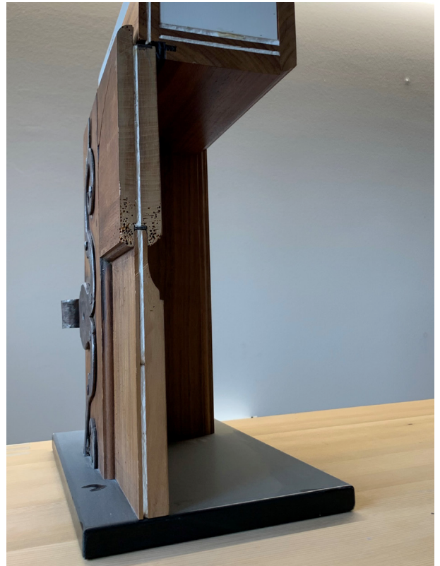
Abb. 15 Türe aufgefräst mit Brandschutz Einlage
