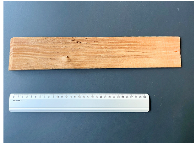
Abb. 16 Brettschindeln mit Fassschnitt Schulhaus Kreuzweg, Herisau
