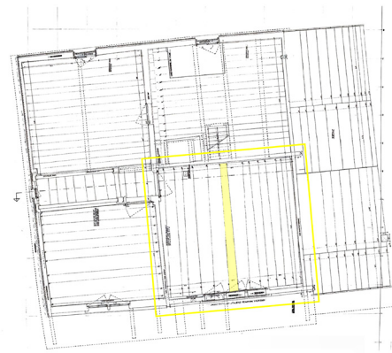
Abb. 19 Schubdielen, Bauaufnahme, Bischofsberg, Heiden Institut für Denkmalpflege und Konstruktionserbe ETHZ 2011
