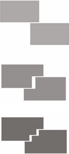
Stumpfer Anschlag, einfacher Falz und doppelter Falz.
